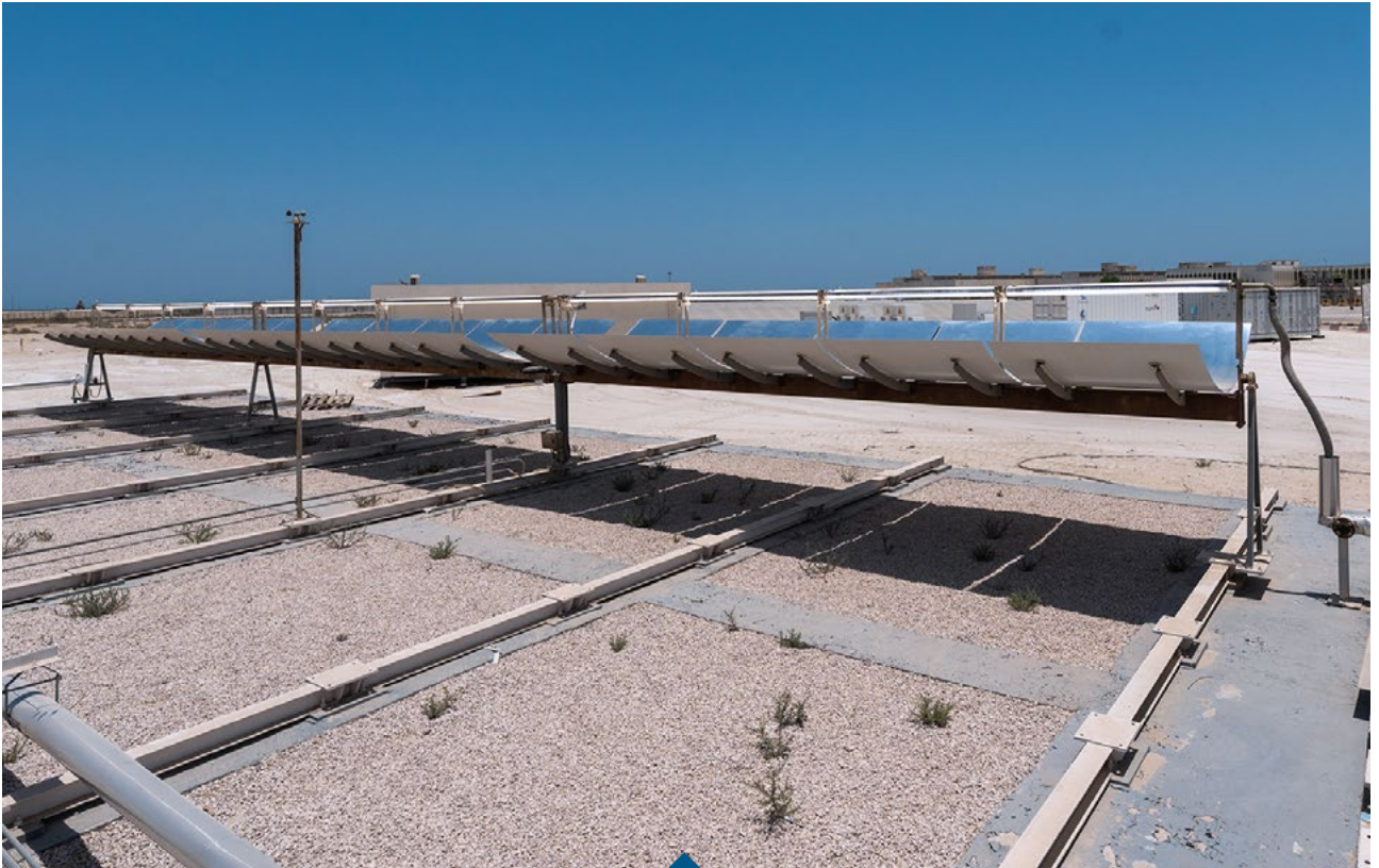
المقوسات الشمسية (CSP) في موقع الاختبار لمحطة التحلية التجريبية بتقنية التناضح الأمامي (FO) في الجبيل
